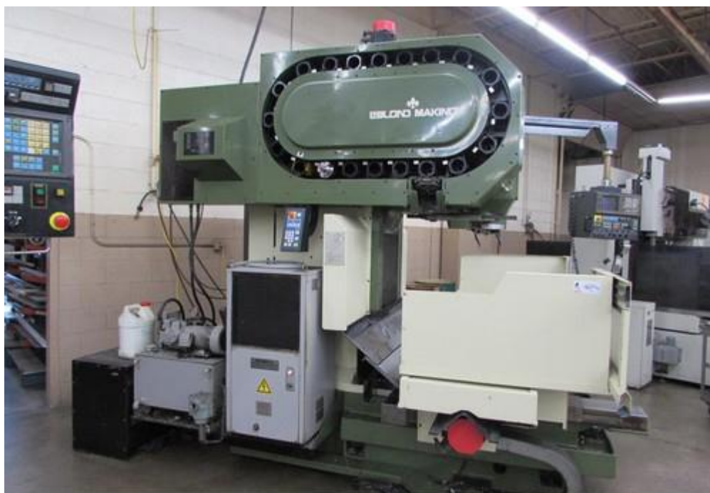
Рис. 5. Инструментальный магазин типа цепной конвейер
