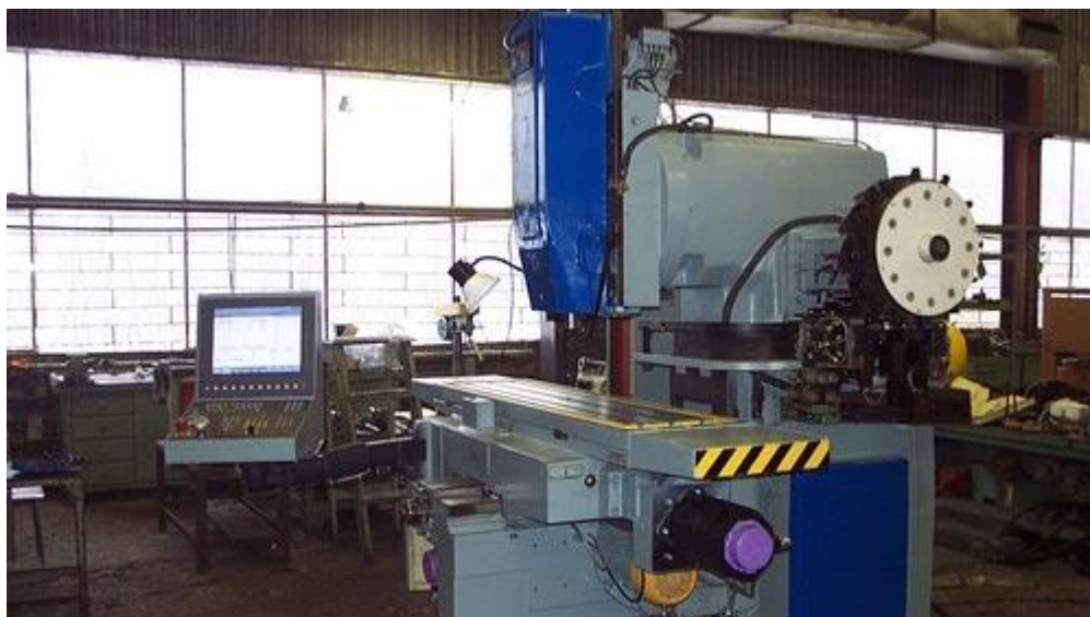
Рис. 4. Вертикальный станок с магазином типа «РУКА» и диском с инструментами
