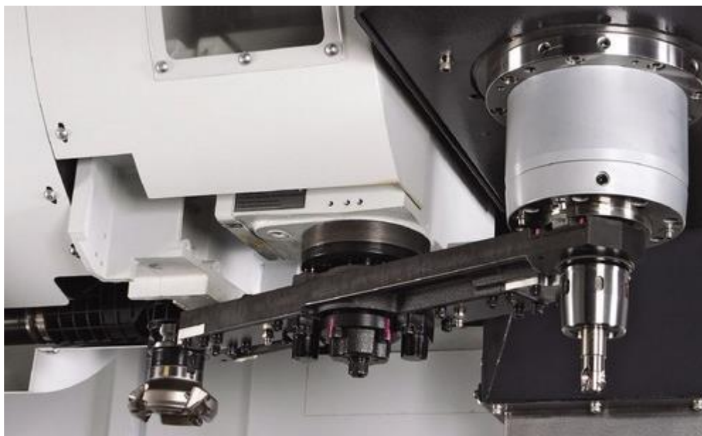
Рис. 6. Инструментальный магазин типа «РУКА»
